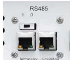
Cổng RS485 để kết nối máy tính. Nó có thể kết nối 1 chuỗi các tủ với nhau và kết nối với máy tính.
