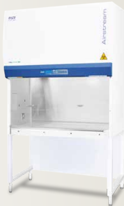
Tủ AC2-S, với vách bên bằng thép không gỉ và khay làm việc liền một tấm.
